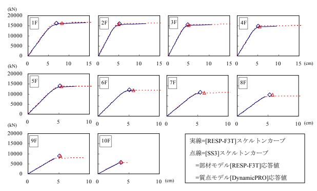
図 3.2.1 スケルトンカーブと最大応答値(層せん断力-層間変位) (非制振)
