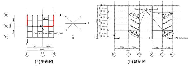
図 2.1.2 粘性ダンパー付きの鉄骨 5 層建物
