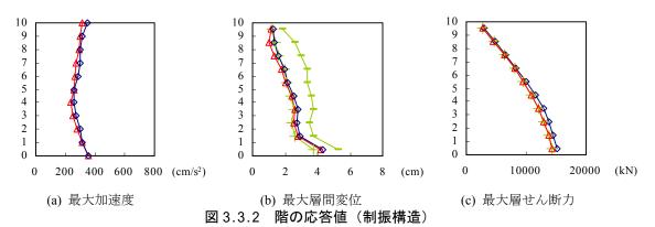
(◇=部材モデル,△=質点モデル,−=静的解析[節点荷重入力],+=静的解析[等価ブレ−ス入力])
