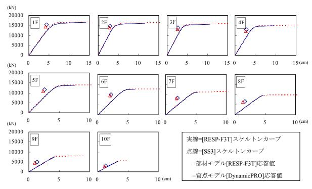
図3.3.1 スケルトンカーブと最大応答値(層せん断力-層間変位)(制振構造)
