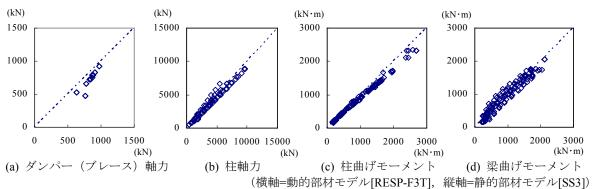
図 3.3.4 部材応力値の比較(静的解析ではオイルダンパーの等価剛性を有するブレースに置換)
