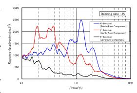
図 2.4.2 加速度応答スペクトル
