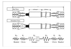
図 2.2.1 粘性ダンパーのモデル化
