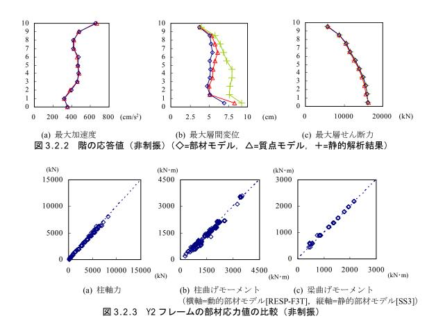
図 3.2.3 は Y2 フレームにおける部材応力値の対比である。同一箇所の柱軸力,柱の曲げモーメント,梁の曲げモーメントについて、部材モデル(RESP-F3T)による値を横軸に、静的解析(SS3)による値を縦軸に示している。非制振では 9 階以下で梁が曲げ降伏しているため、ほとんどの梁の曲げモーメントは全塑性モーメントで一致している。それにより柱の曲げモーメントや軸力に大きな差異がない。
