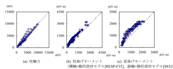
図 3.3.3 部材応力値の比較(静的解析ではオイルダンパーの最大減衰力(軸力)を節点荷重で入力)
