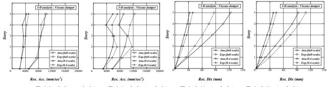
最大加速度(X方向) 最大加速度(Y方向) 最大変位(X方向) 最大変位(Y方向) 図 2.4.1 応答結果と実験結果の比較
